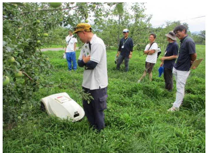
ほ場でのロボット草刈機実演、人（障害物等）にぶつくとバック・方向転換を行う。
