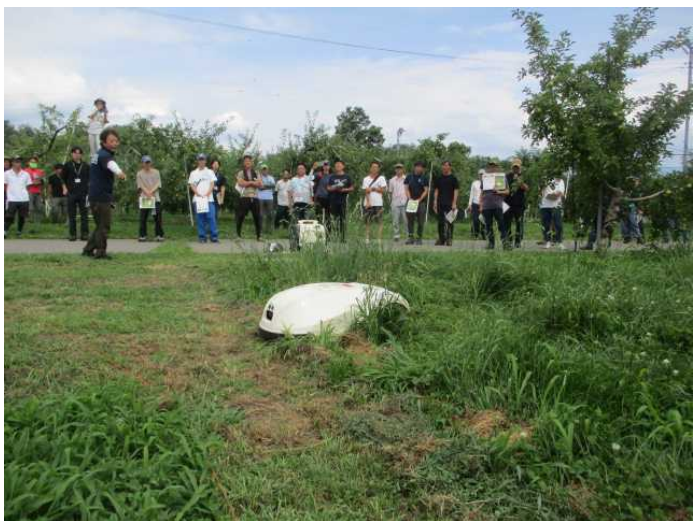
ほ場でのロボット草刈機実演、人（障害物等）にぶつくとバック・方向転換を行う。
